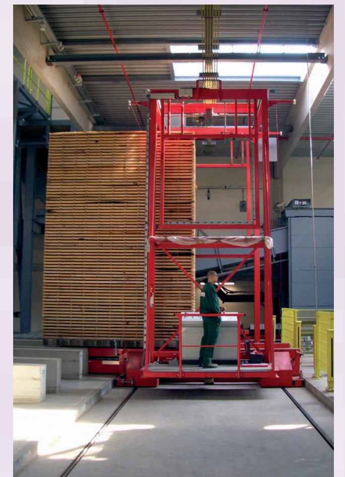
Eines der fahrerlosen Transportsysteme in Aschaffenburg bei der Übernahme eines Bretterstapels
