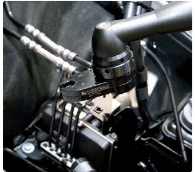
Standardlösung einer Leitungsverschraubung
