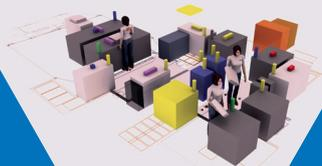
Mittels VISUAL COMPONENTS ist Faurecia in der Lage, schematische Fabriklayouts und detaillierte Produktionslinien abzubilden. Die Verantwortlichen können dabei entweder mit vorhandenen Komponenten aus den Bibliotheken simulieren oder eigene Komponenten hierfür erstellen. Statistische Analysen erlauben gezielte Auswertungen der geplanten Prozesse und Layouts – beispielsweise hinsichtlich der Ressourcenauslastung und Engpässen im System.
